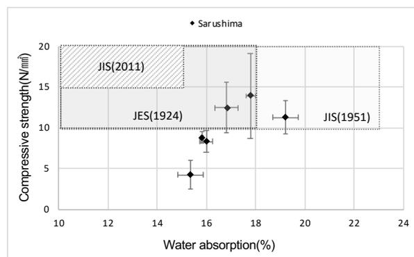
図1 吸水率試験及び圧縮強度試験結果
