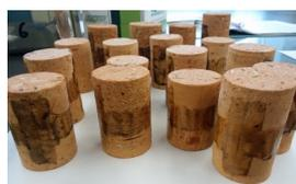
写真2 コア採取された試験体
